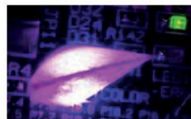
Fig. 5 : La diode RGB a été ici recouverte d'un papier calque pour mieux diffuser la lumière.
